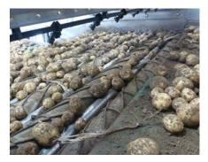
Neu im Lieferumfang von DT Dijkstra ist der Evolution Separator. Dieses innovative Walzenreinigungsset, das unter anderem für Kartoffeln, Zwiebeln und Karotten geeignet ist, verarbeitet schonend den Produktfluss und entfernt Kluten, nassen und losen Boden, Steine, Laub und Unkraut sowohl aus einem trockenen als auch aus einem nassen Produktfluss.
