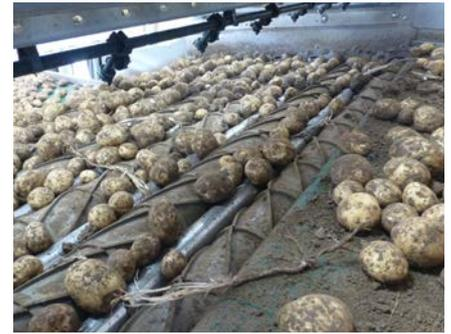
**Neu im Lieferumfang von DT Dijkstra ist der Evolution Separator. Dieses innovative Walzenreinigungsset, das unter anderem für Kartoffeln, Zwiebeln und Karotten geeignet ist, verarbeitet schonend den Produktfluss und entfernt Kluten, nassen und losen Boden, Steine, Laub und Unkraut sowohl aus einem trockenen als auch aus einem nassen Produktfluss.**
