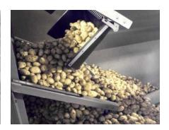
Für die Logistik bei der Verarbeitung von Knollen- und Zwiebelgewächsen entwickelt DT Dijkstra unterschiedliche Lösungen. Kennzeichnend ist, dass die Knollen- und Zwiebelgewächse in einem fortlaufenden Prozess schnell und zielsicher an die richtige Stelle befördert werden, wobei die Produktfreundlichkeit Priorität hat. Die Systeme können separat eingesetzt, aber auch als Gesamtkonzept in neue und bestehende Linien integriert werden.
